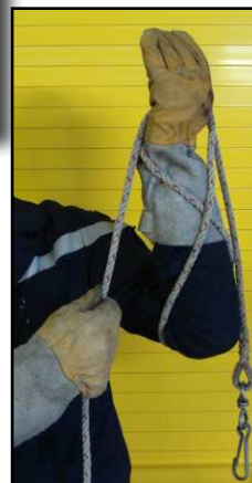
Départ du roulage d'une commande
